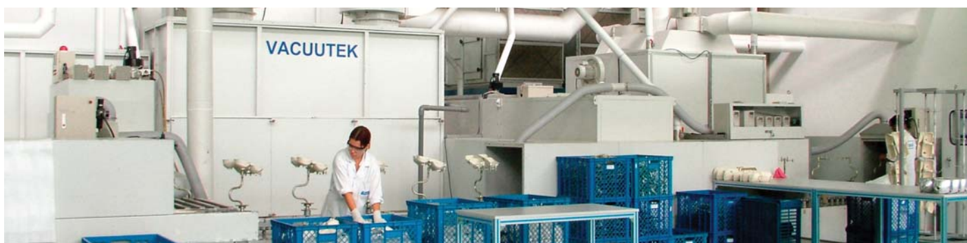
Aplicação e cura de verniz UV para lentes de policarbonato e refletores de BMC com pré-tratamento com UV UV lacquer curing line for PC lens and BMC reflectors with UV pre cleaning
